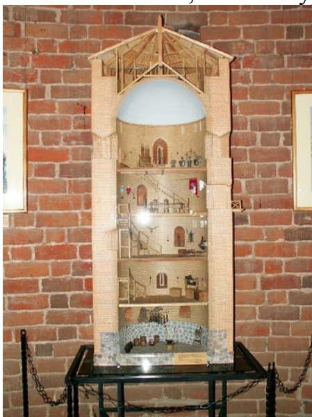
Рис.3 Макет Каменецкой башни в разрезе.
